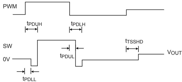
**Figure 1—Timing Diagram**
